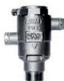
Systemtrenner TYP BA zum Nachrüsten von Außenzapfstellen. Absicherung bis einschließlich Flüssigkeitskategorie 4 nach DIN EN 1717 (höchste Gefahrenklasse, die mit einer Armatur abgesichert werden darf; die höchste Gefährdungskategorie 5 darf nur über einen freien Auslauf abgesichert werden).
