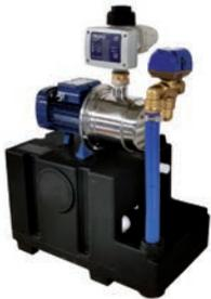
Anschlussfertige Regenwassernutzungsanlage mit automatischer Umschaltung von Regen- auf Trinkwasser und bedarfsgerechter Nachspeisung von Trinkwasser in den darunterliegenden Behälter, gemäß der DIN EN 1717. Motorgesteuertes Zonenventil 1". Schwimmerschalter mit 20 m Gummi-Anschlusskabel und Justiergewicht. Geeignet für Wandmontage.
