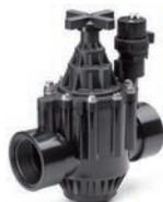
Mit Durchflussmengen- und optionaler Druckregulierung (separat zu bestellen). Durchfluss ohne Druckregulierung 0.45 - 34.05 m<sup>3</sup>/h, mit Druckregulierung 1.14 - 34.05 m<sup>3</sup>/h. Betriebsdruck 1.04 - 10.4 bar.
