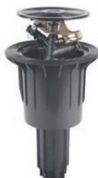
Schwinghebel-Versenkregner mit Impulsantrieb für Golf-Fairways, Fußballplätze, Sportanlagen, Pferde-Rennbahnen und Parks. Mit 2 und 3 Düsen. Alle Teile inkl. Spule von oben ohne Grabarbeiten tauschbar. Handbedienung von oben möglich. Düsengrößen 7.0 - 17.5 mm, mit Standarddüse 9.0 mm (Teilkreis) und 13 mm (Vollkreis) ab Werk (#Düsengröße bei Bestellung angeben).
