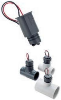
Einfacher Durchflusssensor zur Verwendung mit Hunter ACC2 und älteren I-CORE / ACC Steuergeräten. Unterbricht die Wasserzufuhr bei zu hohem Durchfluss. Max. 300 m Abstand zwischen Modul und Sensor. Erfordert Sensor-T-Stück, in das der Sensor installiert wird. 5 Jahre Herstellergarantie.
