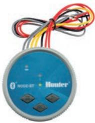
Batteriebetriebenes Bluetooth-Steuergerät zur direkten Montage in der Ventilbox. Bedienung über das Smartphone, ohne die Ventilbox öffnen zu müssen. 15 m maximale Kommunikationsreichweite. Wasserdicht (IP68). Kompatibel mit Hunter Klik Sensoren und Bodenfeuchtesensor SC-PROBE. Magnetventil, Spezialmagnetspule 9V und 2 x 9V Blockbatterie, nicht im Lieferumfang enthalten, siehe Seite 130. 2 Jahre Herstellergarantie.
