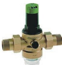
Hochwertige, DVGW-zertifizierte Ausführung. Gehäuse und Verschraubungen aus Messing. Feinsieb aus nichtrostendem Stahl. Inkl. Siebtasse und Federhaube mit Verstellgriff und Einstellanzeige. Bis 16 bar Vordruck, Hinterdruck 1,5 - 6 bar (voreingestellt auf 3 bar).
