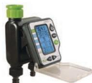
Batteriesteuerung zur Montage im geschützten Außenbereich am Außenwasserhahn. Großes, abnehmbares Display für eine einfache Programmierung in 3 Schritten. 1 Programm, Beregnungsdauer 1-240 min, 4 Startzeiten pro Tag, mind. 1 Beregnungszeit pro 15 Tage. Durchfluss mind. 5 l/min, max. 40 l/min. Betriebsdruck 1-6 bar. Eingang 3/4" und 1" IG. Ausgang 3/4" AG und Klick-Anschluss. 2 Batterien AA erforderlich (nicht im Lieferumfang enthalten, siehe Seite 130).
