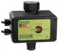
Druck- und durchflussabhängige Steuereinheit zur automatischen Ein- und Ausschaltung von Pumpen. Lieferung inkl. 1.5 m Kabel und Stecker.
