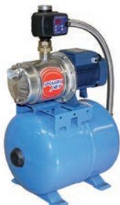
Anschlussfertiges Hauswasserwerk mit selbstansaugender Pumpe. Inkl. elektronischem Druckschalter (schützt die Pumpe vor Trockenlauf und schaltet die Pumpe automatisch druckabhängig ein und aus; beinhaltet ein Manometer zur Überwachung des Anlagendrucks) und 24 L Ausdehnungsbehälter (schützt die Pumpe vor zu häufigem Ein- und Ausschalten). Verkabelt mit 1,5 m Kabel und Schukostecker. Saug-/Druckanschluss 1" IG.
