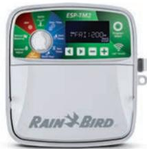
Elektrisches Steuergerät für den Hausgartenbereich. Schnelle Programmierung in nur 3 Schritten. 3 Programme mit bis zu 4 Startzeiten je Programm. Mit vorinstalliertem Netzanschlusskabel im Innen- und Außenbereiche einfach zu installieren. Anschluss Regensensor möglich. WLAN fähig durch optionales WLAN-Modul. Steuerung über Smartphone/Tablet möglich. 230/24 VAC. 3 Jahre Herstellergarantie.
