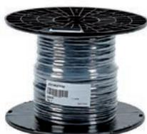
Beregnungskabel 0.8 mm<sup>2</sup>. Starre, blanke Kupferdrähte mit farbig kodierter Aderumhüllung. Zur Aktivierung von 24 V Ventilen. Max. 350 m Distanz zwischen Steuergerät und Ventil.
