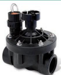
Robustes Magnetventil aus glasfaserverstärktem Kunststoff. Mit Durchflussmengenregulierung und optionaler Druckregulierung bzw. Abstreifvorrichtung (reinigt bei jedem Öffnen und Schließen des Ventils den Filter aus Edelstahl). Durchfluss 1.2 - 45.0 m<sup>3</sup>/h. Betriebsdruck 1.4 - 13.8 bar. Herstellergarantie 5 Jahre.
