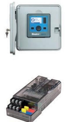
Wie Hunter ACC2 (siehe oben), jedoch als Decoder-Variante mit 75 Stationen im Grundmodell, erweiterbar auf 150 oder 225 Stationen. Gleichzeitiger Stationsbetrieb von bis zu 30 Magnetspulen. Verwenden mit Hunter ICD-Decodern über ID-Leiter: Bis zu 3 km (2 mm<sup>2</sup> Leiter) bzw. bis zu 4.5 km (3 mm<sup>2</sup> Leiter). Bis zu 3 Zweileiterwege pro Ausgangsmodul. Diagnose, darunter Decoder-Bestand, Kabelfinder, Magnetspulen-Sucher und mehr. 230/24 VAC. 5 Jahre Herstellergarantie.
