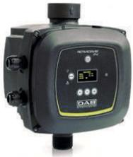
Inverter/Frequenzregler zur Steuerung von Hydraulikpumpen. Hoher Komfort und Energieeinsparung durch konstanten Druck. Inkl. Drucksensor, Durchflusssensor und Rückschlagventil. Schützt vor Trockenlauf und Überlastung. Vertikal und horizontal einbaubar. Anschluss Saugseite 1¼“ AG, Druckseite 1 ½“ IG. Lieferung inkl. 1.5 m Kabel und Stecker.
