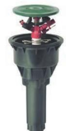
Schwinghebel-Versenkregner mit Impulsantrieb, optimal für Parks und Grünstreifen an den Straßenrändern. Düsengrößen 2.8, 3.2 und 3.5, mit Standarddüse 3.2 mm ab Werk (#Düsengröße bei Bestellung angeben).
