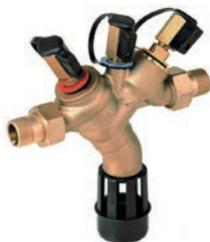
Kompaktausführung mit Gewindeanschluss. Dreifache Sicherheit: Zwei Rückflussverhinderer und ein Ablassventil unterteilen den Systemtrenner in drei Druckzonen. Absicherung bis einschließlich Flüssigkeitskategorie 4 nach DIN EN 1717 i.V.m. DIN 1988-100. DVGW-zertifiziert. Betriebsdruck mindestens 1.5 bar, max. 10 bar.
