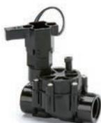
Typ „DV“ (ohne Durchflussmengenregulierung): Durchfluss 0.05 - 9.08 m<sup>3</sup>/h. Betriebsdruck 1.0 - 10.4 bar. Herstellergarantie 5 Jahre.
