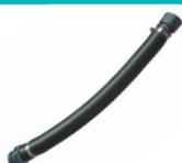
Schneller Anschluss des PE-Rohrs an die Ventilbox mit flexiblem SmartConnect. Anschlüsse bis 6 bar. Verwendung nur nach dem Magnetventil, damit kein permanenter Druck ansteht.
