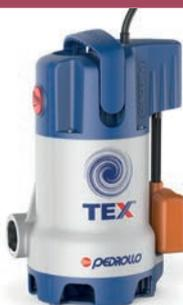
Schmutzwasserpumpe für Feststoffe bis zu einem Durchmesser von Ø 30 mm. 5 m max. Eintauchtiefe (mit ausreichend langem Kabel). Absaughöhe bis zu 35 mm über dem Boden. Einstellmöglichkeit für automatischen oder manuellen Betrieb. 5 m Stromkabel mit Schuko Stecker (10 m Stromkabel auf Anfrage). Vertikaler Magnet-Schwimmerschalter (einstellbar). Druckanschluss 1 1/4" IG oder Ø 40 mm Schlauchanschluss.
