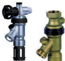
Nachrüstsystemtrenner für Außenzapfstellen. Einfache Handhabung durch drehbares Gehäuse und optimiert angeordnetem Gehäuse, der ein Abknicken des angeschlossenen Schlauchs verhindert. Absicherung bis einschließlich Flüssigkeitskategorie 4 nach DIN EN 1717. DVGW Zertifikat beantragt. Eingangsdruck mindestens 1.5 bar, max. 10 bar.
